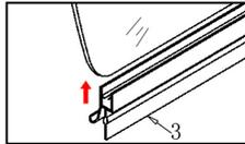
Drehen Sie die Glasscheibe so weit heraus, dass Sie die Dichtung von unten aufdrücken können.
