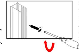
Stecken Sie die Schraube durch das U-Profil und drehen diese in den Dübel hinein. Bevor Sie die Schrauben richtig festziehen, richten Sie die Schiene noch mal mit einer Wasserwaage aus.
