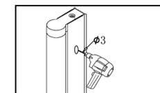
Bohren Sie mit einem Bohrer der Stärke 3mm an den vorgebohrten Stellen im Profil ein Loch in das Aluminiumprofil des Glaselements.
