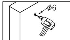
Bohren Sie mit einem Bohrer der Stärke 6mm die angezeichneten Löcher in die Wand.
