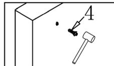
Drücken Sie die Dübel in die zuvor gebohrten Löcher. Sollten sich die Dübel nur schwergängig in die Löcher drücken lassen, nehmen Sie den Gummihammer zur Hand.
