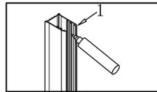
Richten Sie die U-Profilschiene mit einer Wasserwaage aus und zeichnen Sie mit einem Stift die drei Bohrlöcher an.
