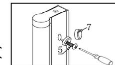
Nehmen Sie die Unterlegscheibe und schieben diese auf die Schraube. Drehen Sie die Schraube in das Aluminiumprofil und drücken die Abdeckkappe drauf.
