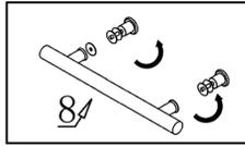
Lösen Sie durch drehen die Schrauben am Griff. Schieben Sie eine Gummiunterlegscheibe auf die Schraube und schieben diese durch das Loch im Glas. Schieben Sie eine weitere Gummiunterlegscheibe auf die Schraube und drehen anschließend den Griff drauf. Wiederholen Sie diesen Schritt mit der anderen Schraube.
