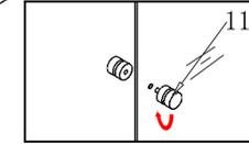
Drehen Sie den Griff auf und setzen Sie den Griff wie abgebildet wieder zusammen. Achten Sie darauf, dass zwischen Glas und Griff je eine Gummidichtung ist.
