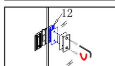
Lösen Sie die Schrauben am Scharnier und setzen Sie das Scharnier von außen gegen das Glas und schrauben Sie es wie abgebildet wieder zusammen.
