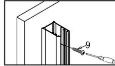
Setzen Sie nun die Wandschiene an der Wand an und drehen die Schrauben in die Dübel. Richten Sie die Leiste nochmals mit einer Wasserwaage aus und ziehen die Schrauben fest.
