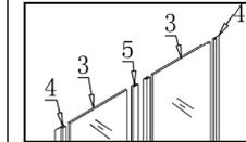
Schieben Sie die Magneteleiste auf die Vorderkante der Tür auf. Schieben Sie die h-Dichtung so auf das Glas auf, das die breite Kante innen ist.
