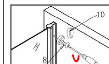
Schieben Sie die Unterlegscheibe so auf die Schraube, das die flache Seite auf das U-Profil aufliegt. Drehen Sie die Schraube in das Profil und schieben die Abdeckkappe auf.
