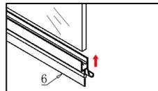
Schieben Sie die Türdichtung auf die Unterkante des Seitenelements auf.
