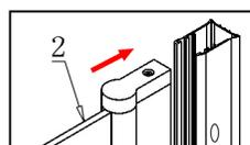
Schieben Sie das Seitenelement in die U-Profilschiene hinein. Achten Sie dabei auf die angebrachte Türdichtung.
