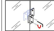
Lösen Sie die Schrauben am Scharnier. Setzen Sie die Scheibe ein und montieren das Scharnier wie abgebildet wieder zusammen.
