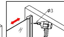
Bohren Sie mit einem 3mm Bohrer ein Loch in das Aluminiumprofil des Seitenelements bis zur ersten Luftkammer.
