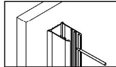
Richten Sie das U-Profil mit einer Wasserwaage aus und zeichnen Sie die Bohrlöcher an der Wand an.
